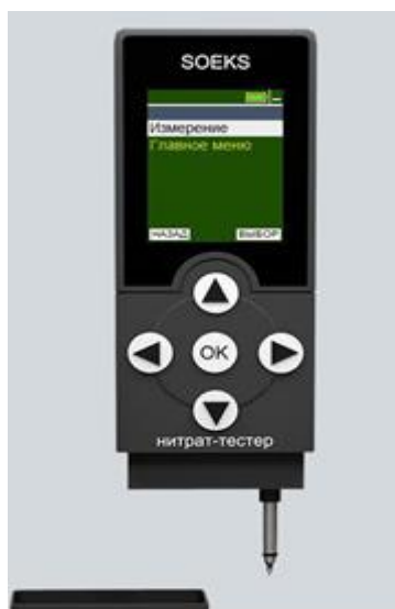
Рис. 2.1. Нітрат-тестер СОЭКС NUC–019–1
