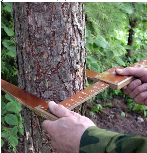
Рис. 3. Вимірювання діаметру стовбура мірною вилкою.
