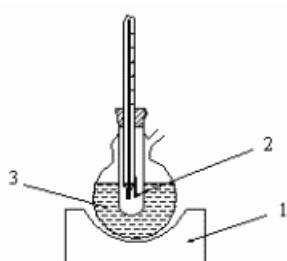
Запаяний з одного кінця капіляр (2), у який поміщають речовину, має внутрішній діаметр 0,8-1,0 мм і довжину 35-45 мм. Капіляр наповнюють речовиною так, щоб щільний шар його займав 3-4 мм. Для утворення щільного шару речовини капіляр кидають запаяним кінцем униз через скляну трубку діаметром 10 мм і висотою 60-80 см, що стоїть вертикально на годинному склі. Капіляр (2) за допомогою гумового кільця прикріплюють до термометра і поміщають у прилад.
